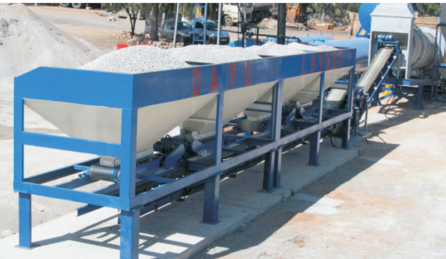
Sistema de suministro de agregados en frío Cold aggregate supply system
